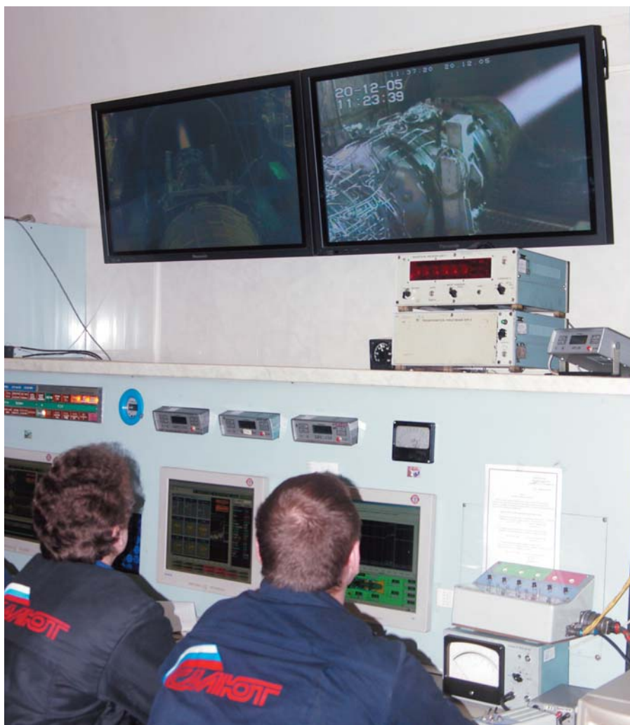
Испытание двигателя АЛ-31Ф, оснащенного соплом с всеракурсным УВТ, на стенде ММПП «Салют»
