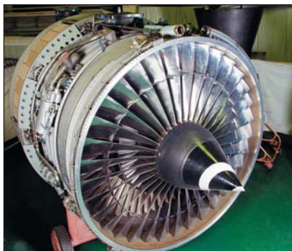
Один из первых совместных проектов российских и зарубежных моторостроителей – модифицированный двигатель ПС-90А2. Недавно он поступил на испытания
